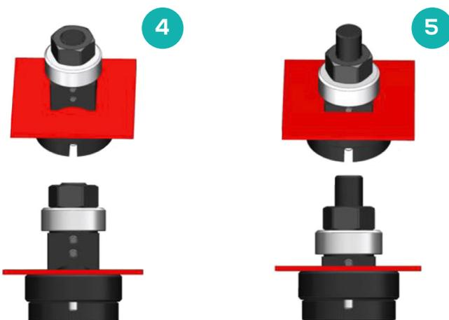
Ajuste el tornillo con la mano hasta que el macho y la hembra toquen la chapa.
