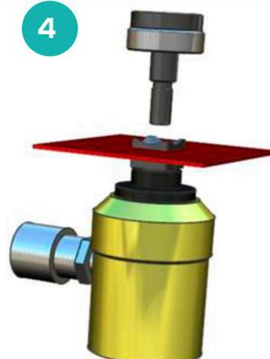
Desmonte el perforador del cilindro hidráulico y extraiga la chapa.
