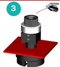
Engrase el perforador y la chapa para facilitarte el corte
